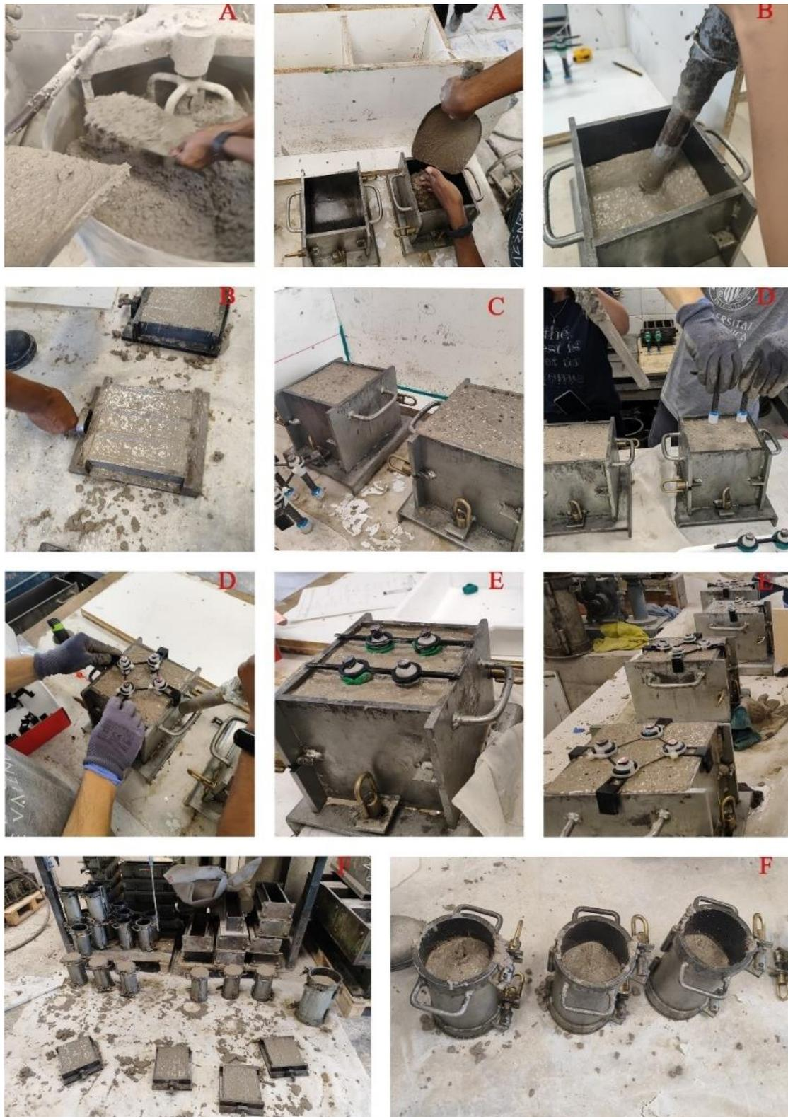
Figura 3. 5. Fabricación de hormigones. A. Hormigonado por tongadas, B. Vibrado de probetas. C. probetas vibradas, D. Colocación de sensores en hormigón con ayuda de un vibrador, E. Sensores colocados, F. Probetas para la caracterización vibradas.
