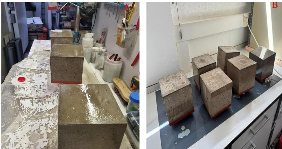
Figura 3. 9. Impermeabilización con impregnación hidrófuga e inhibidor de la corrosión Sikagard-705 L. A. Grupo CP ( $t=0$  días), B. Grupo CPT ( $t=183$  días)
