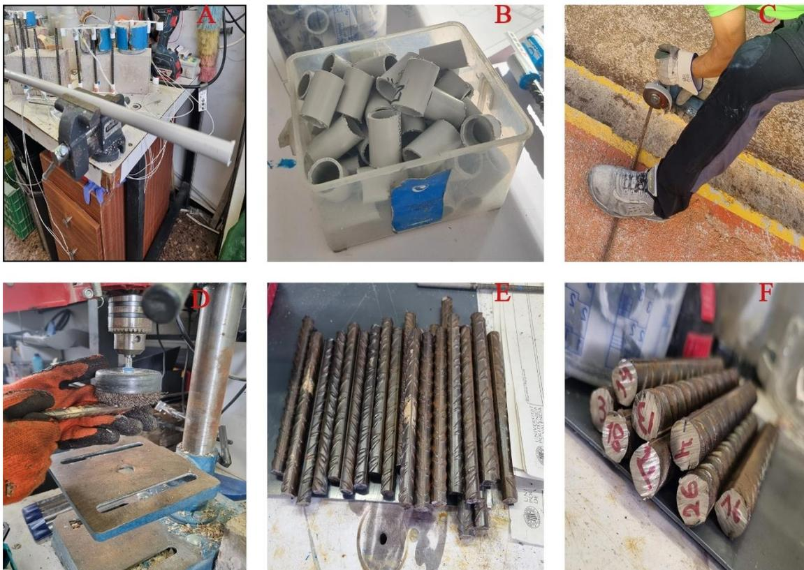
Figura 3. 2. Fabricación de sensores. A. Sujeción de tubería en el sargento, B. Piezas cortadas de 20 mm y 30 mm de tubo de PVC, C. Corte de armaduras ( $L=120$  mm), D. Cepillado mecánico de armaduras en taladro de columna. E. Armaduras limpias, F. Identificación numérica de las armaduras.
