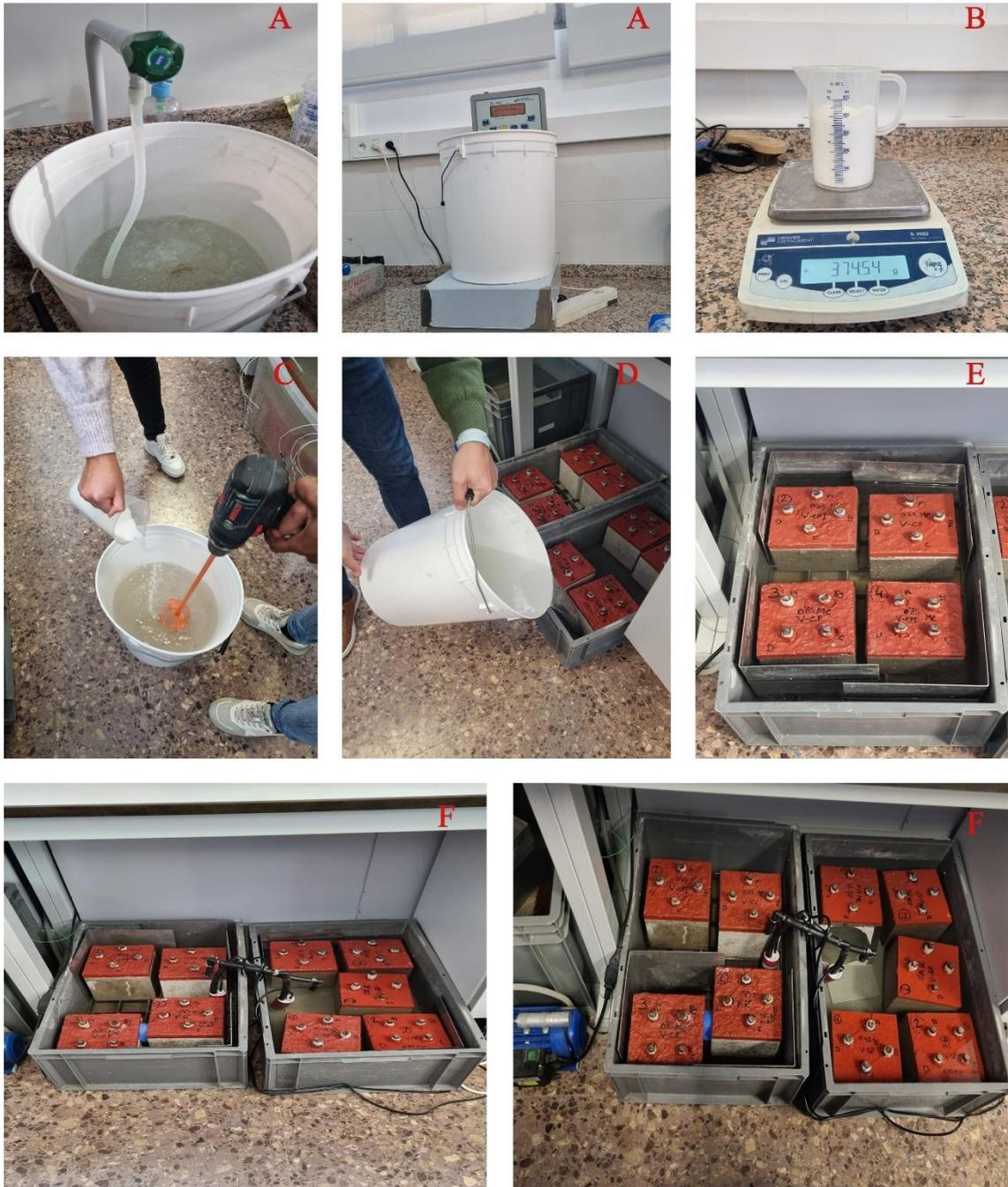
Figura 3. 11. A. recogida y pesado del agua de grifo, B. Pesado de la sal común. C. Mezcla de agua con sal con taladro con broca mezcladora. D. Vertido de agua con sal en las cubetas, E. Agua con sal en cubetas hasta la marca de impermeabilización de probetas, F. Montaje final del sistema con las bombas.
