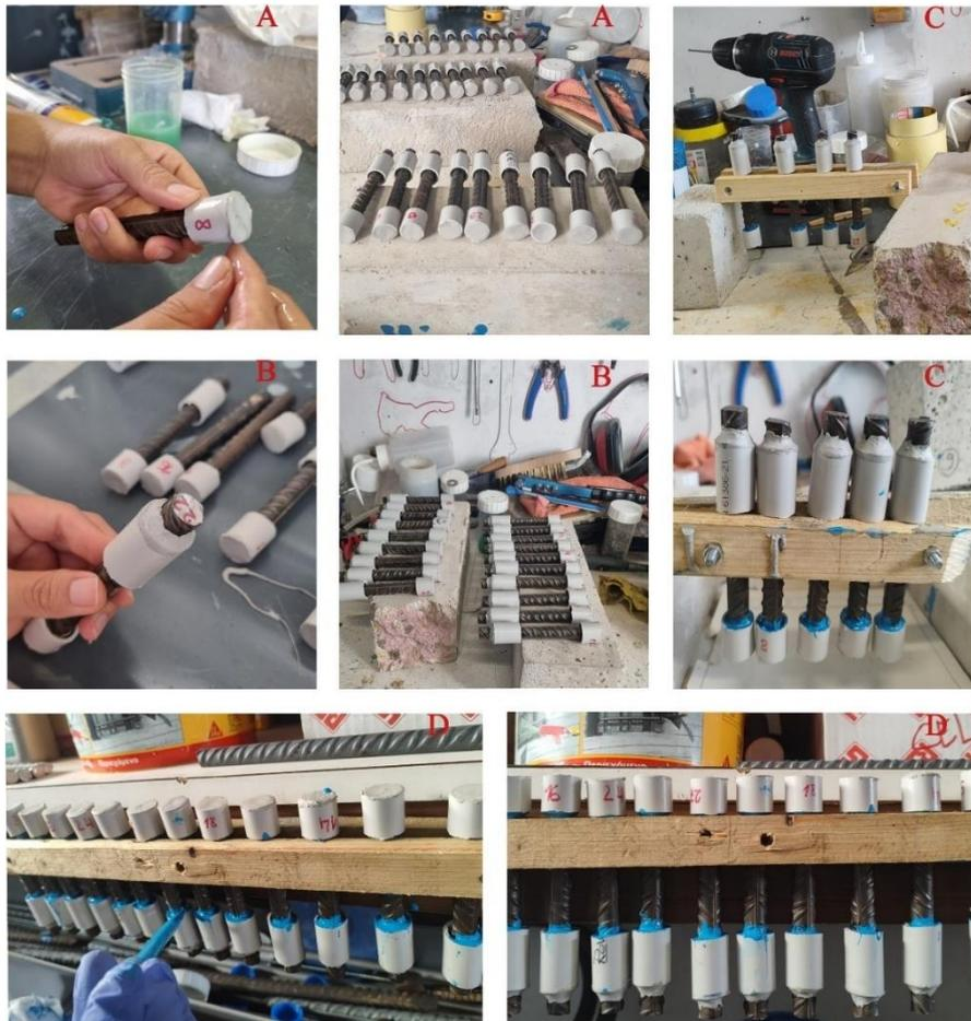
Figura 3.3. Fabricación de sensores. A. Encamisado de sensores parte inferior (A) y superior (B) con Sikaflex 111. C y D. Sellado con Sikaguard 62 parte inferior (C) y superior (D)
