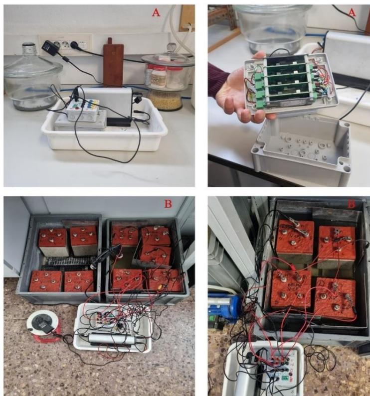
Figura 3. 13. Monitorización de la corrosión en probetas. A. Equipo de microprocesadores. B. Conexión de sensores al equipo de microprocesadores.
