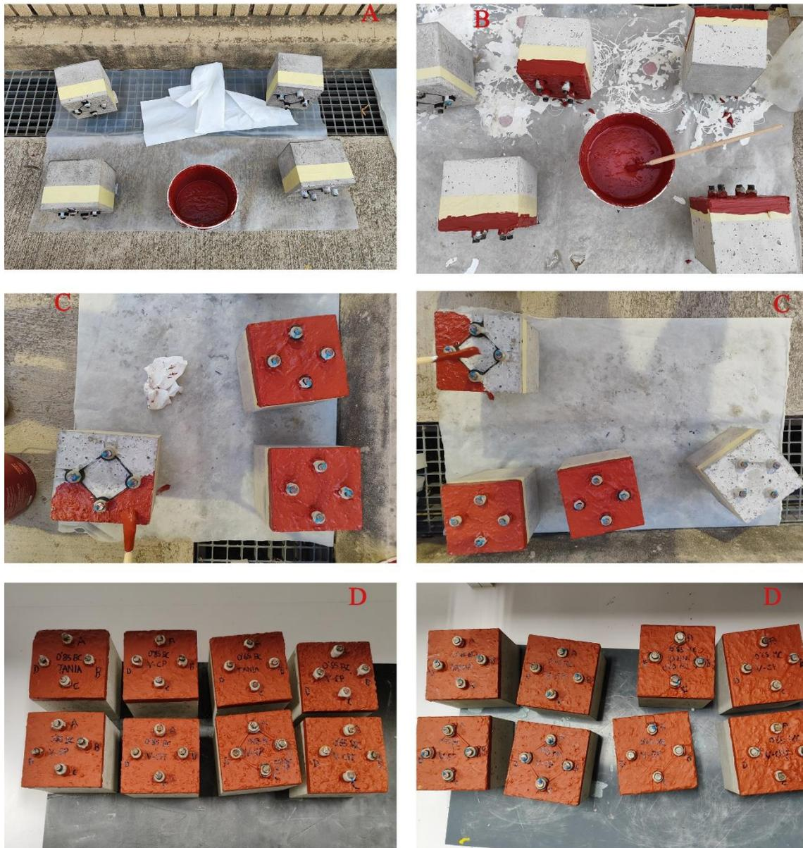
Figura 3. 8. Preparación probetas. A. Marcado de 10 mm en caras laterales de probetas con cinta de carrozero. B. Impermeabilización laterales probetas. C. Impermeabilización caras superiores probetas. D. Identificación probetas según grupo SP, CP, CPT.
