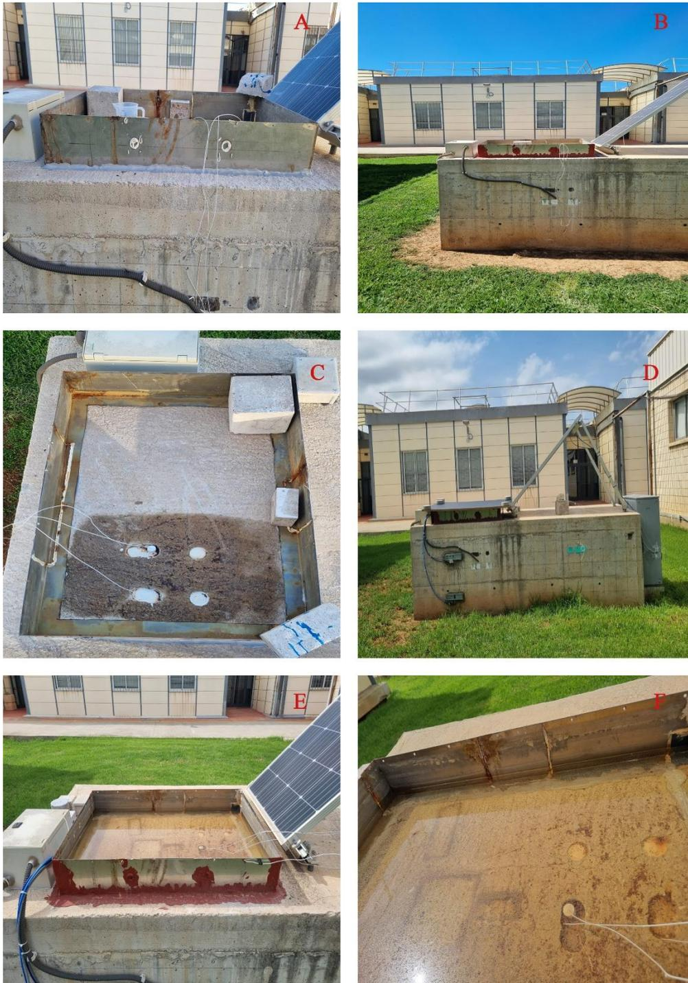
Figura 3. 17. Intervención estructura real. A y B. Colocación depósito de agua de mar con sellado de juntas, C. Aplicación de inhibidor de la corrosión Sikaguard-705L aplicado, D. Sistema de monitorización montado, E. Agua de mar con el nivel bajado, F. Presencia de fisuras en la zona de los sensores.
