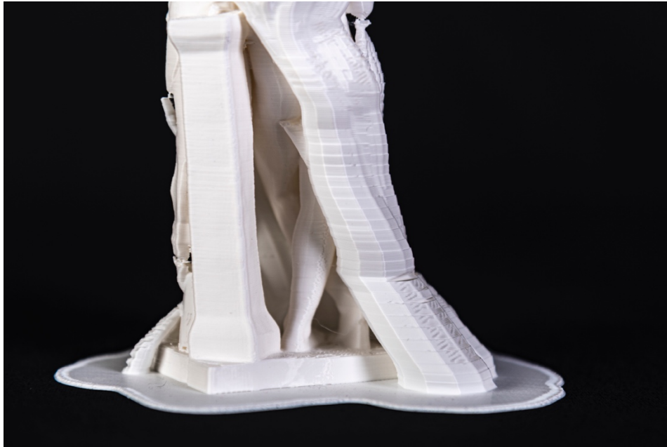
Fig. 5 Prueba de impresión Nº 1 "Niño de la flauta" junto a la configuración de soportes de árbol como estrategia estética.
