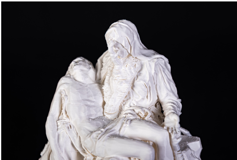
Fig. 4 Prueba de impresión nº3 del escaneado 3D de la piedad de Miguel Ángel aplicando los soportes de árbol como estrategia estética. Fuente: Català, R (2024)
