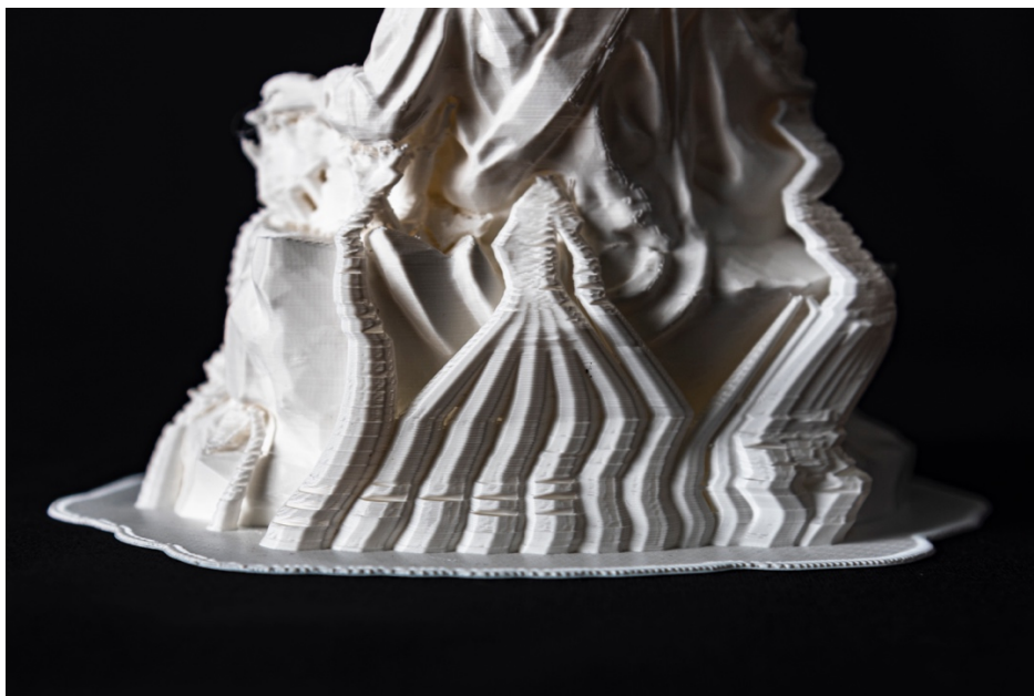
Fig. 1 Soportes de árbol en una de las pruebas de impresión de esta investigación. Fuente: Català, R (2024)
