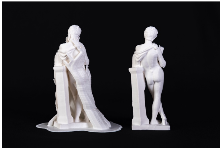
Fig. 6 y 7 Comparación de las pruebas de impresión 1 y 2 donde observamos la misma pieza de escultura clásica mediante una reproducción exacta a escala y la pieza junto a los soportes de árbol como estrategia estética. Fuente: Català, R (2024)
