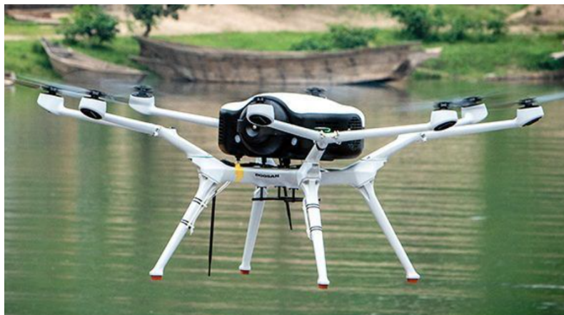
Figura 3.1: Ejemplo de dron con sistema propulsivo de hidrógeno. Fuente: [97]
