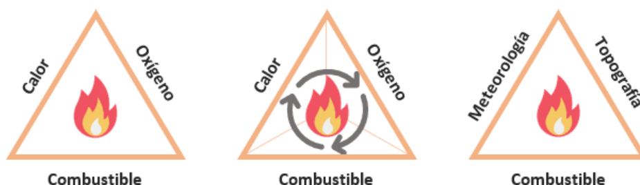
Figura 16.- Triángulo del fuego, tetraedro del fuego y triángulo del comportamiento del fuego. Fuente: elaboración propia.
