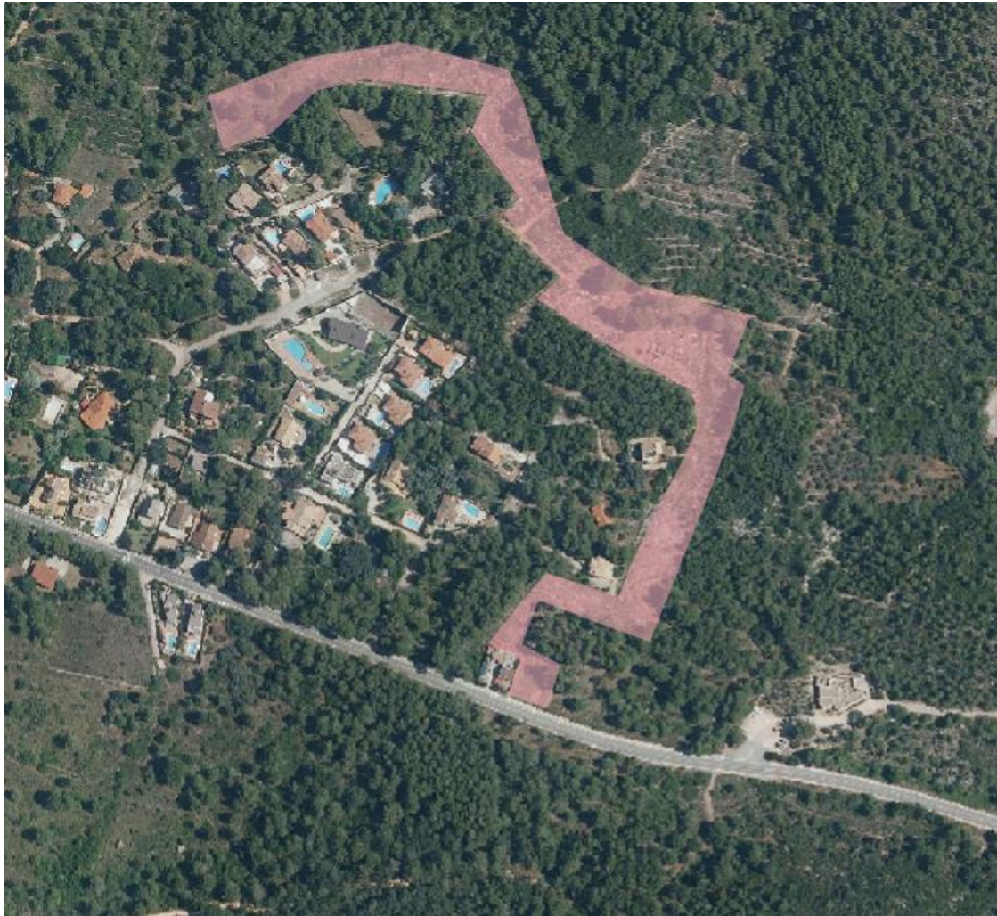
Figura 51.-Ejemplo de Faja perimetral en IUF sin tratamiento interior en los jardines
