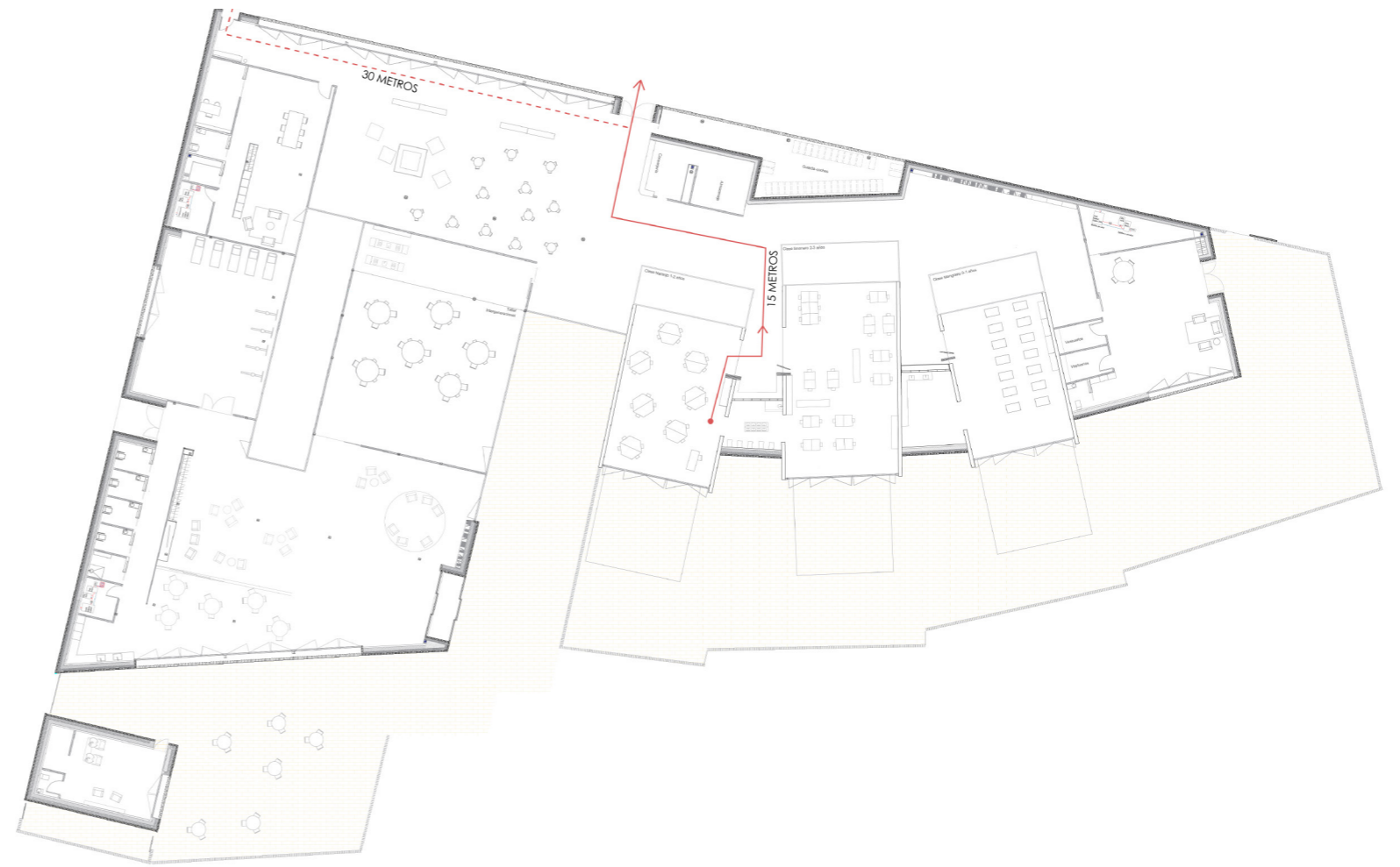
Ruta de evacuación 1
