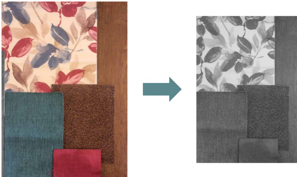
Figura 38. Medición LRV con vista monocromática del móvil. Adaptado de (Halsall & Macdonald, 2015).
