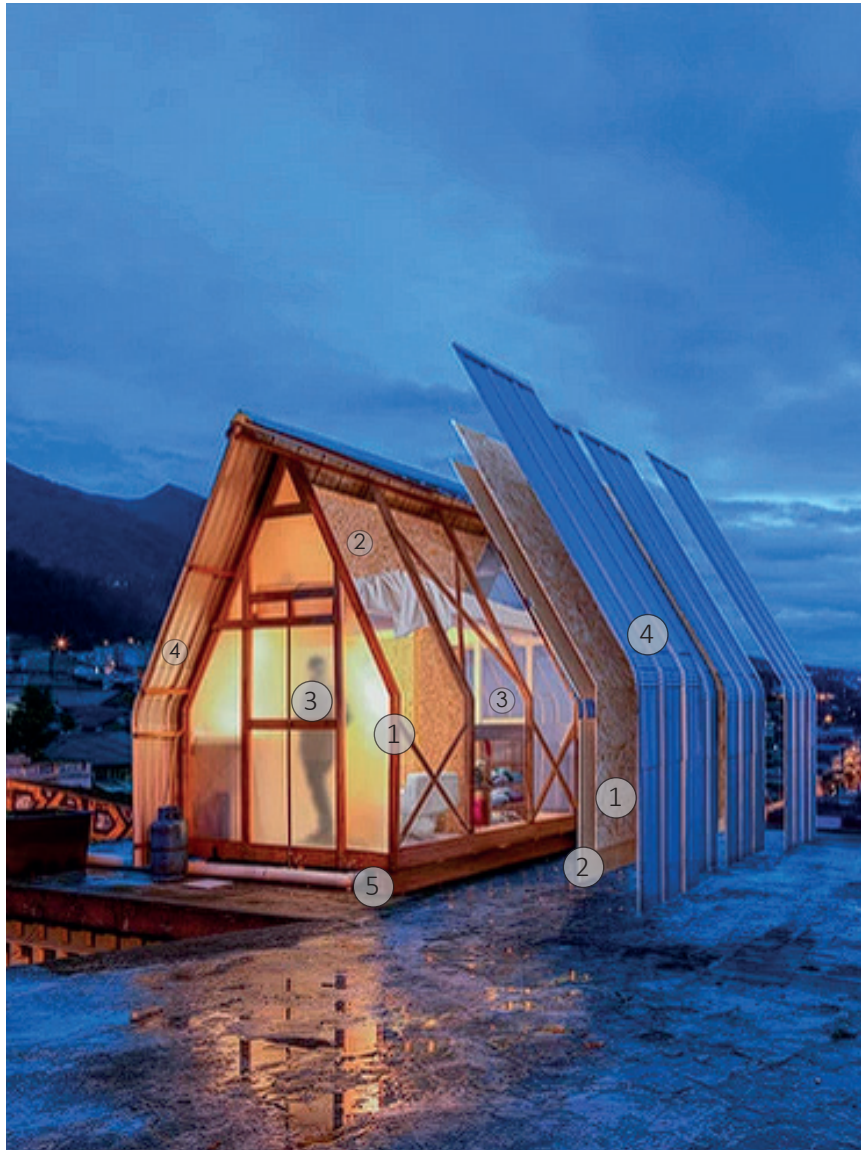
Imagen 137. Despiece de materiales. Fuente: El Sindicato Arquitectura, 2023
