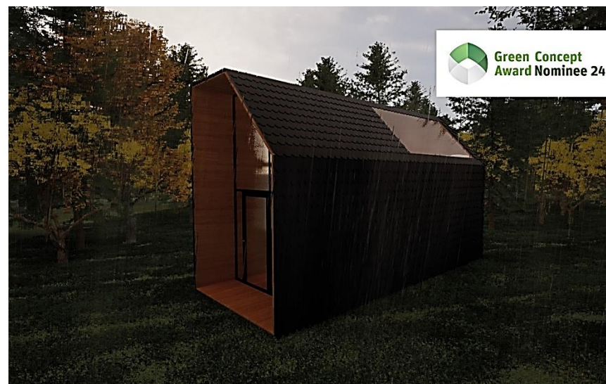
Imagen 128. Propuesta de tiny house con revestimiento en caucho de neumáticos para mitigar la problemática habitacional. Fuente: UAI, 2024
