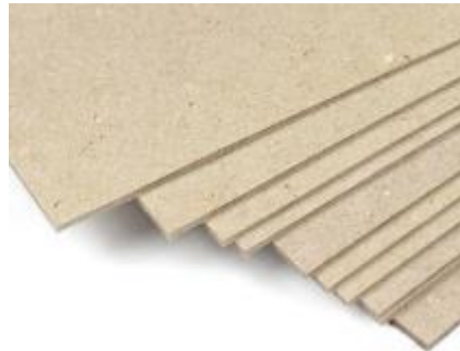
Ilustración 45. Cartón compacto prensado de alta densidad
