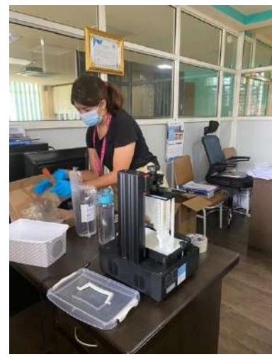
Imagen 92. Preparación para despegar el modelo 3D impreso de la impresora. Elaboración propia.
