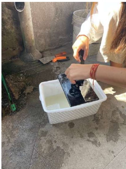
Imagen 93. Limpieza de la placa de la impresora 3D. Elaboración propia
