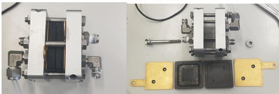
Figura 47. Vista del desmontaje de la monocelda.
