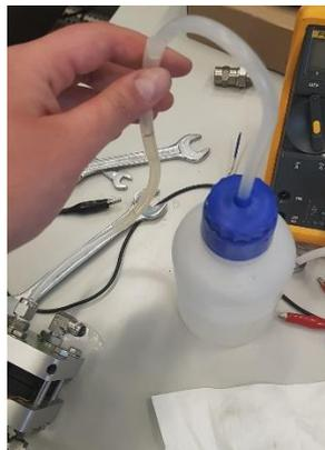
Figura 49. Hidratación de la membrana en la monocelda.
