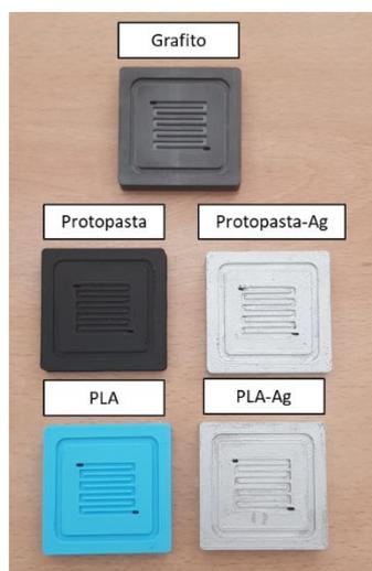
Figura 57. Fotografía de las placas bipolares caracterizadas.
