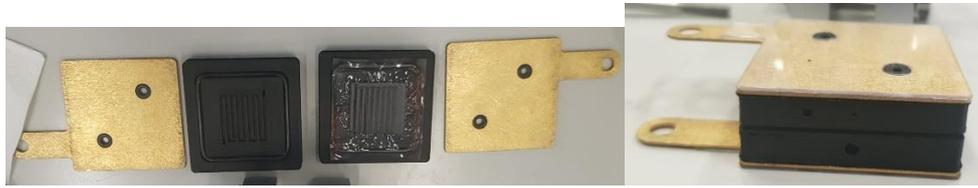
Figura 48. Montaje de la MEA en las placas bipolares.
