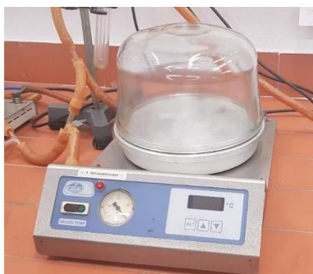
Figura 38. Desecador al vacío Vacuo-Temp JP Selecta.
