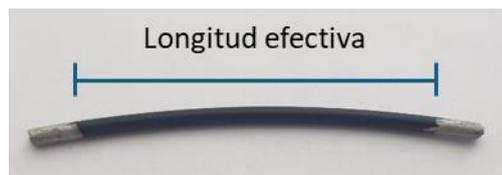
Figura 62. Muestra de hilo de Protopasta® empleado para la medición de cuatro puntas.
