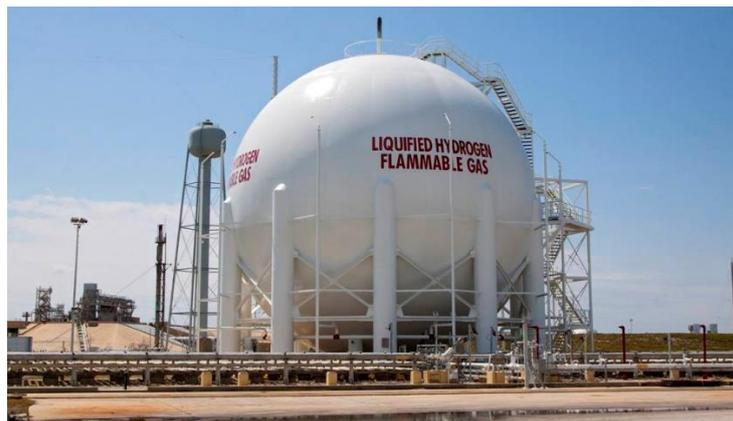
Figura 8. Tanque de almacenamiento de hidrógeno líquido de forma esférica (Pérez, 2022)
