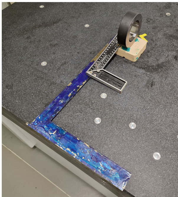
Figura 75. Escuadras utilizadas para alinear correctamente el anillo patrón
