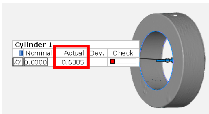
Figura 102. Escaneo 1, posición 1 (1.1.). Tolerancia de cilindridad. Anillo patrón. Escáner EinScan
