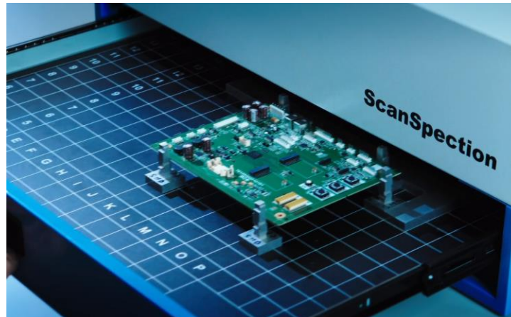
Imagen 5: Control de calidad con tecnología AOI 2D Fuente: Foto tomada en la empresa
