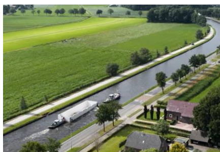
FIG 29_Transporte de las viviendas flotantes
