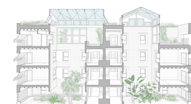
Figura 2.4.19. Sección fugada con patios climáticos.
