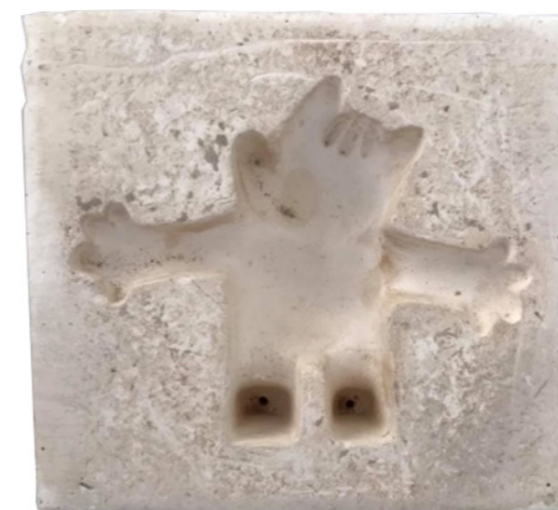
Figura 129 Molde de figura de Cobi.
