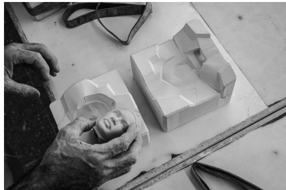
Figura 38: Desmoldeo de porcelana. Fuente: Lladró (s.f.)
