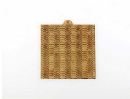
Figura 85: Línea de Corte Ondulada
