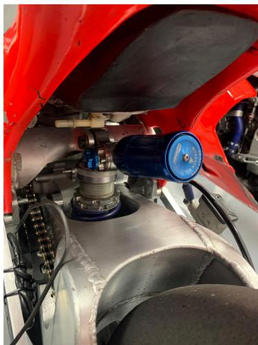
**Figura 3.14** *Amortiguador trasero Gubellini Racing*
