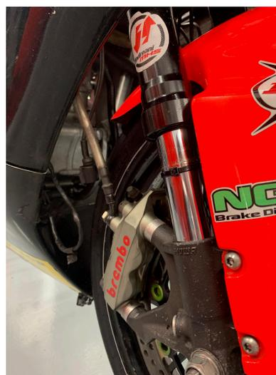
**Figura 3.9** Pinza de freno Brembo
