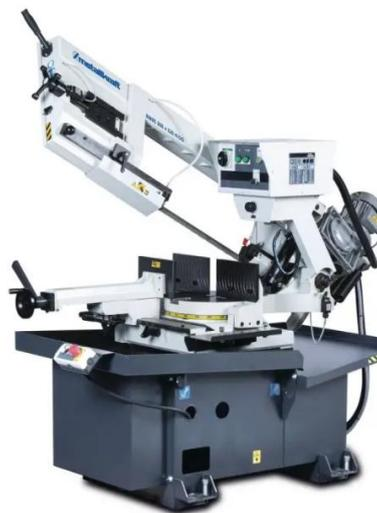
*Ilustración 18: Sierra fija Metalkraft. Fuente: Maquituls, s.f.*
