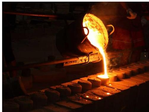
*Ilustración 17: Fundición en arena. Fuente: Aeisa, s.f.*
