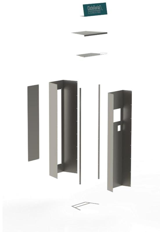
*Ilustración 45: Render vista explosionada máquina de alquiler. Fuente: elaboración propia*
