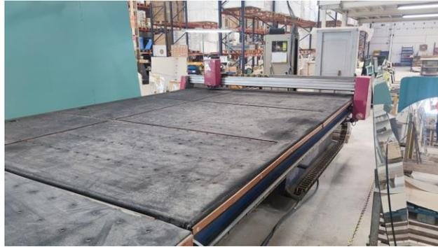
*Figura 49: Cortadora de vidrio monolítico CNC MACOTEC MS-3 .Fuente: Elaboración propia*
