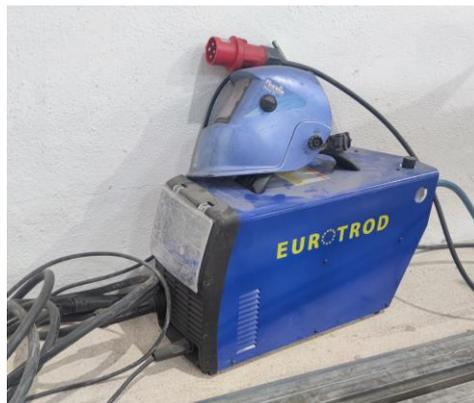
*Figura 52: Cortadora de plasma EUROTROD Samurai 65i. Fuente: Elaboración propia*
