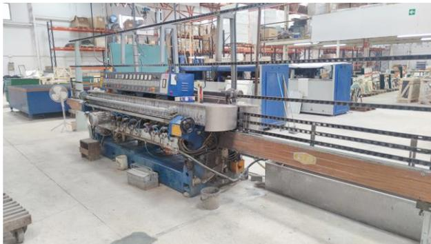
*Figura 50: Canteadora lineal BOVONE mini max 371 .Fuente: Elaboración propia*
