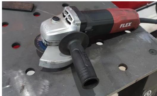
Figura 54: Amoladora angular FLEX LE 14-11 125. Fuente: Elaboración propia
