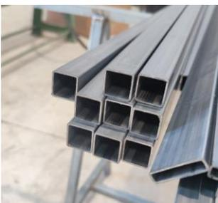
Figura 42: Tubo de acero 25x25mm. Fuente: Elaboración propia
