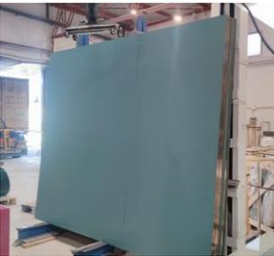
Figura 44: Plancha de vidrio 4mm. Fuente: Elaboración propia
