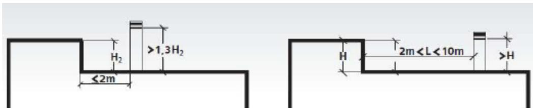
Ilustración 23. Esquema de altura libre de obstáculos, boca de expulsión. Fuente: CTE HS-3
