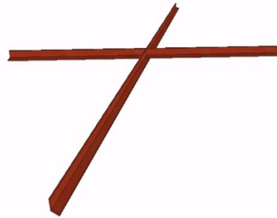
Ilustración 20. Arriostramiento de los cordones
