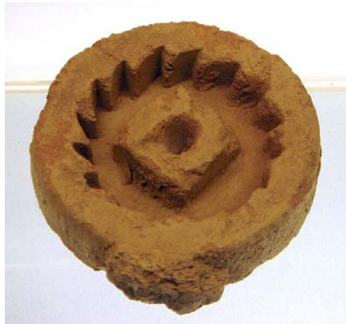
Figura 2.1.1 Molde chino para fabricar engranajes de bronce (siglos II a.C. a III d.C.) [12]
