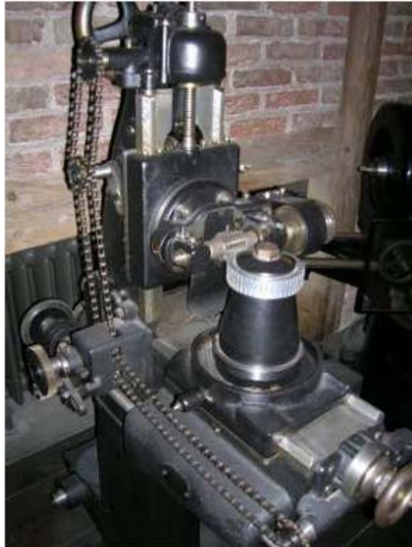
Figura 2.1.15 Máquina de Robert Hermann Pfauter para fabricar en engranes mediante fresa madre [11]
