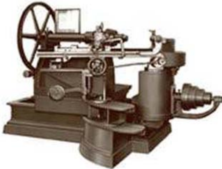
Figura 2.1.14 Fresadora de engranajes cónicos desarrollada por William Gleason [11]
