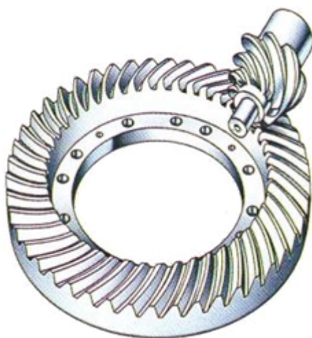
Figura 2.1.22 Mecanismo piñón-corona con engranes chevrón o doble helicoidales [21]
