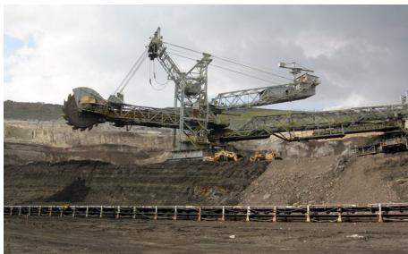
Figura 2. Màquina d'explotació ( rotopala 7 ) en la mina de As Pontes.
