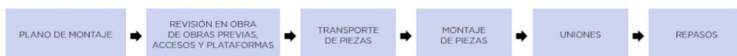
Figura 62: Planificación y montaje de obras prefabricadas. Fuente: Revista Hormigón al Día, Instituto del Cemento y del Hormigón de Chile (2020).
