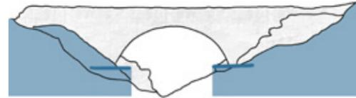
Imagen 5.6. Esquema marcado cimentación fachada aguas abajo (alzado sureste) del acueducto de Carbonera. Fuente: Elaboración propia
