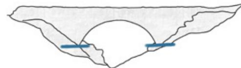
Imagen 5.7. Esquema marcado estribos fachada aguas abajo (alzado sureste) del acueducto de Carbonera. Fuente: Elaboración propia
