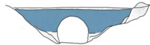
Imagen 5.21. Esquema marcado ubicación tímpanos y relleno. Fachada aguas abajo (alzado este) del acueducto de Els Arcs. Fuente: Elaboración propia
