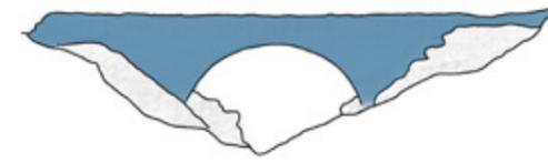
Imagen 5.12. Esquema marcado tímpano y relleno fachada aguas arriba (alzado noroeste) del acueducto de Carbonera. Fuente: Elaboración propia
