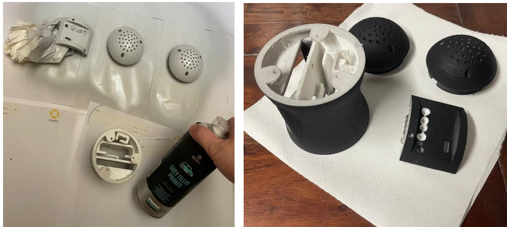
Figuras 95 y 96. Imprimación y pintura de las piezas
