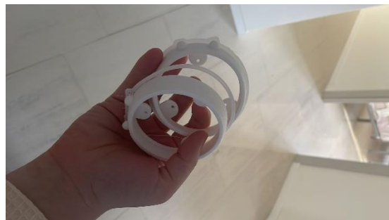
Figuras 87, 88, 89, 90 y 91. Impresión 3D y lijado del resto de piezas
