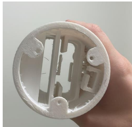
Figuras 85 y 86. Segundo intento impresión 3D de pieza principal
