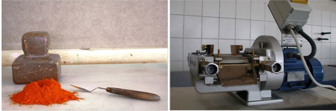
Figuras 1 y 2. Equipos de amasado del color, manual (izqda..) y mecánico (dcha). Archivo personal.
