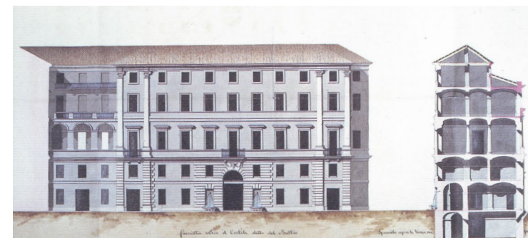
Fig 5.6 Alzado norte y sección transversal de la manga del Palazzo di Città
