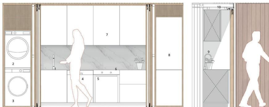
Figura 4.12 Alzado y sección del mueble longitudinal en la parte de la cocina. Fuente: Azalea.
