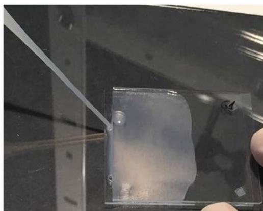
Imagen 10. Llenado de una celda por capilaridad.
