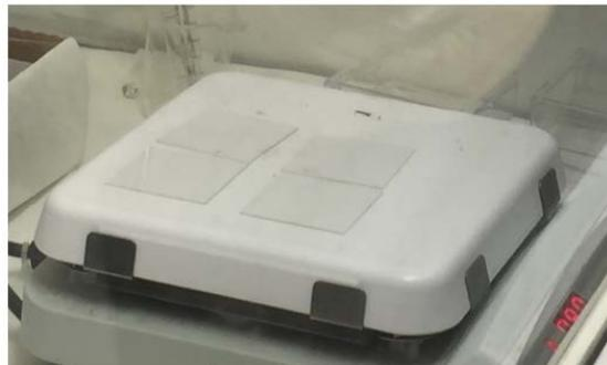
Imagen 5: Curado del polímero en una placa calefactora de laboratorio.
