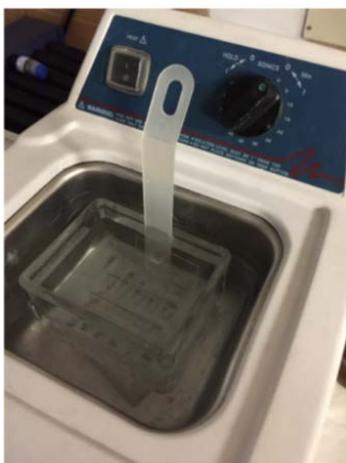
Imagen 3: Baño ultrasónico para la limpieza de los vidrios.
