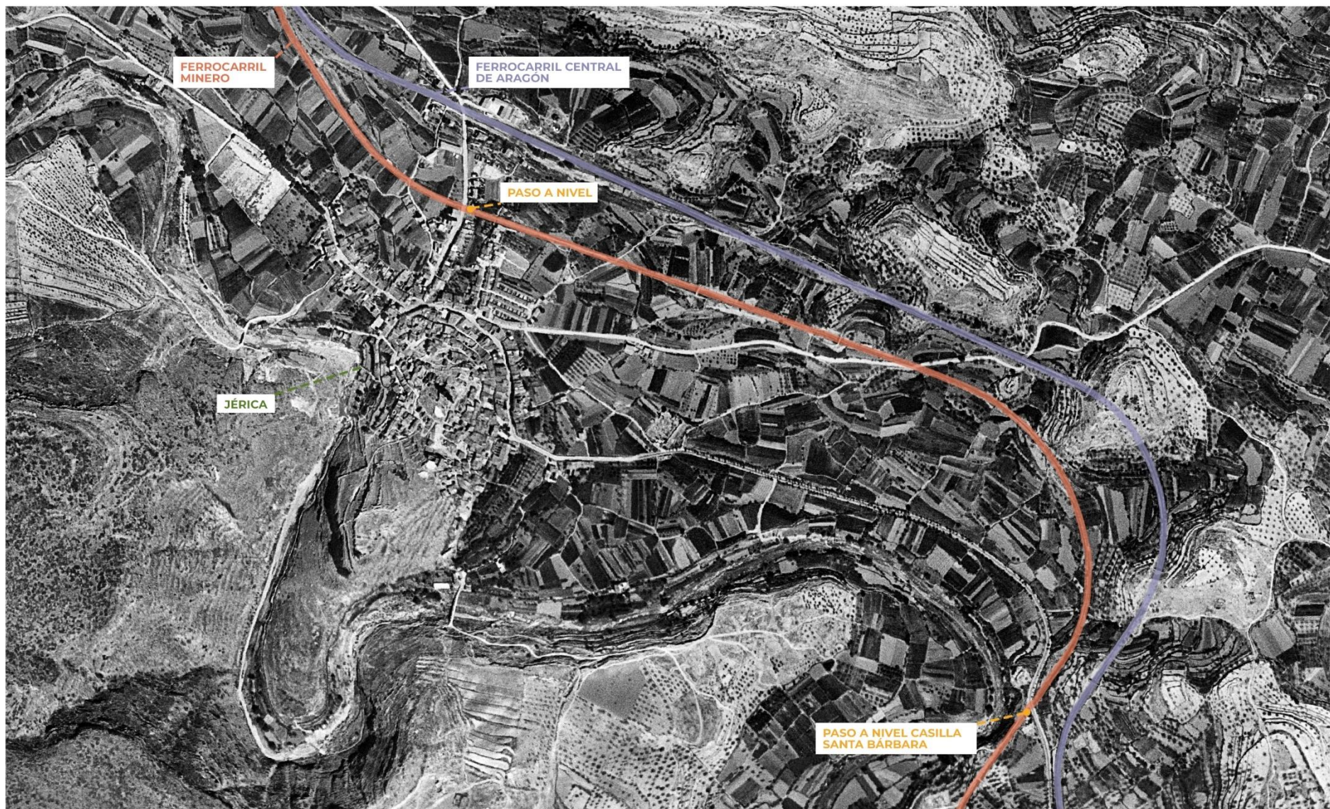
Figura 35. Vuelo de 1956, Jérica. Escala 1:10.000. En rojo aparece el ferrocarril minero, en azul el ferrocarril Central de Aragón, y en amarillo los pasos a nivel. Elaboración propia a partir de la base de datos del IDEV
