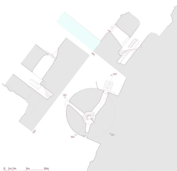
Figura 7. Planta, secciones del estado actual del Cubo de Aguada, a partir del levantamiento realizado.
