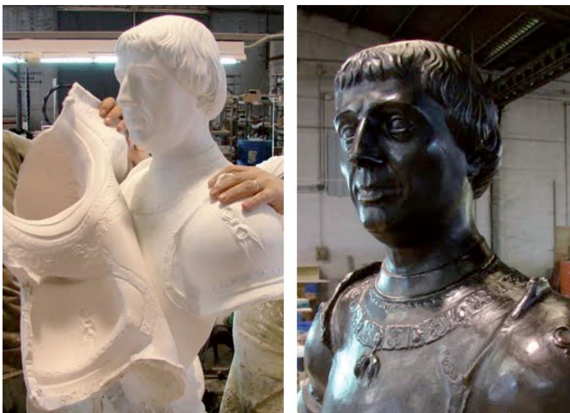
Figura 3. Silicona partiendo de un modelo en espuma mecanizado con celda robotizada. Reproducción del busto de Alfons El Magnánim escaneado tridimensionalmente, que finalmente es fundido en bronce a la cera perdida. Coordinación: Manuel Martínez Torán, 2008 para el Palau de la Generalitat vía IVACOR. Fuente: Jaume Espí, escultor y fundición a la cera perdida (Carlet)
