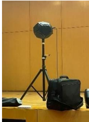
Ilustración 11: Fuente dodecaédrica Omni-Power, Modelo 4292-L
