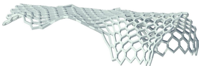
Figura 8. Estructura de malla que conforma el revestimiento superior del hábitat proyectado (4).
