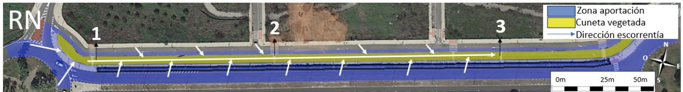
**Figura 2** | Superficies generadoras de escorrentía que alimentan a la cuneta vegetada de la Ronda Norte y los puntos de muestreo en la cuneta, 1 (inicial), 2 (intermedio) y 3 (final).
