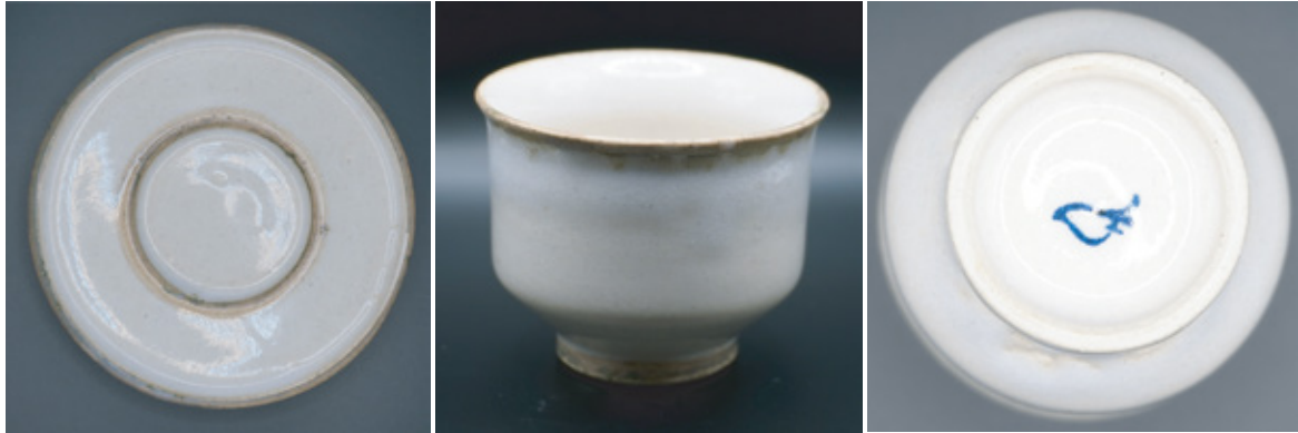
Figura 85. Pruebas de color con esmalte brillante y pigmento verde Fuente: Elaboración propia
