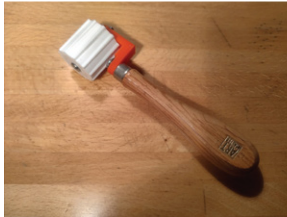
Figura 88. Segunda versión del rodillo con mango ergonómico Fuente: Elaboración propia
