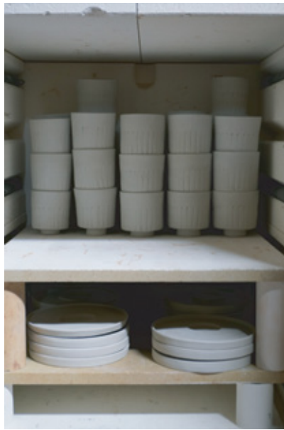
Figura 199. Carga del horno para bizcochado Fuente: Elaboración propia
