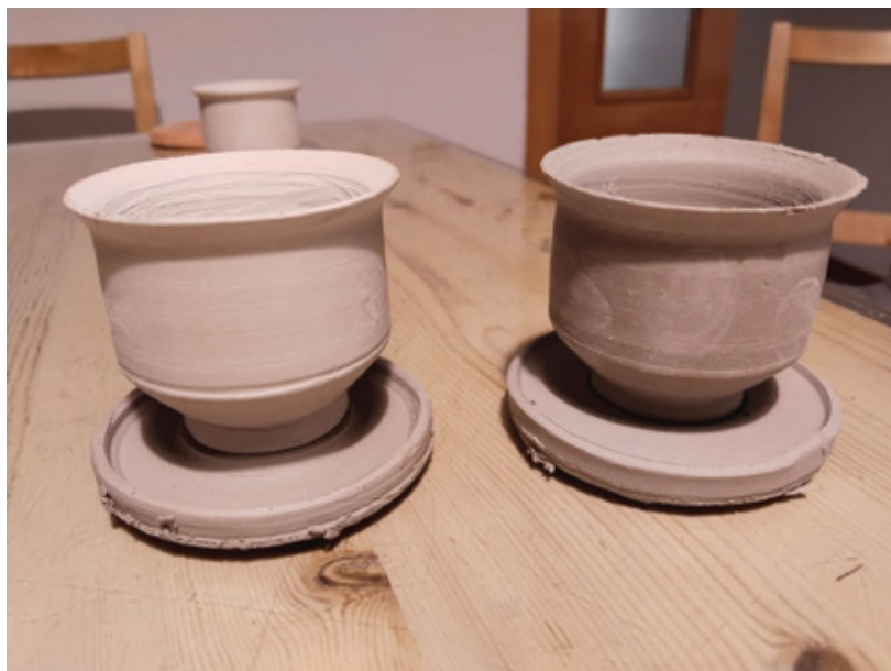
Figura 80. Primeros modelos de la jícara #1 y platillo previo retorneado Fuente: Elaboración propia
