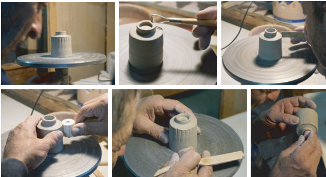
Figura 197. Proceso de retorneado de jícaras
