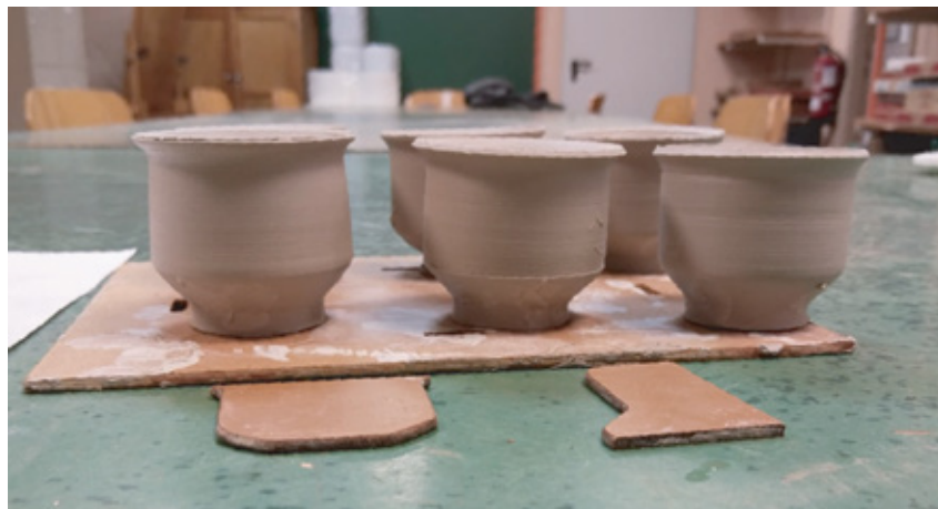
Figura 79. Primeros modelos de la jícara #1 y terrajas Fuente: Elaboración propia
