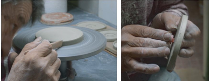
Figura 196. Retorneado de platillos Fuente: Elaboración propia
