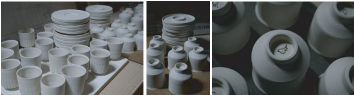
Figura 200. Piezas tras bizcochado Fuente: Elaboración propia
