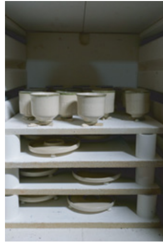
Figura 205. Descarga del horno tras alta temperatura Fuente: Elaboración propia
