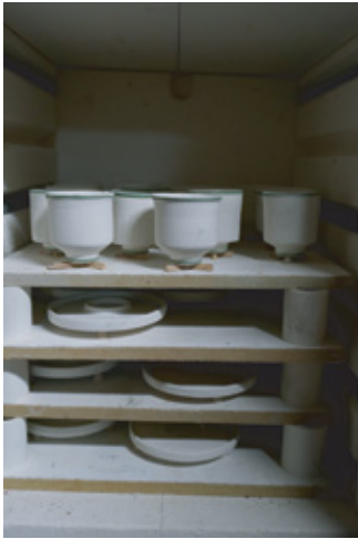
Figura 204. Carga del horno para alta temperatura Fuente: Elaboración propia
