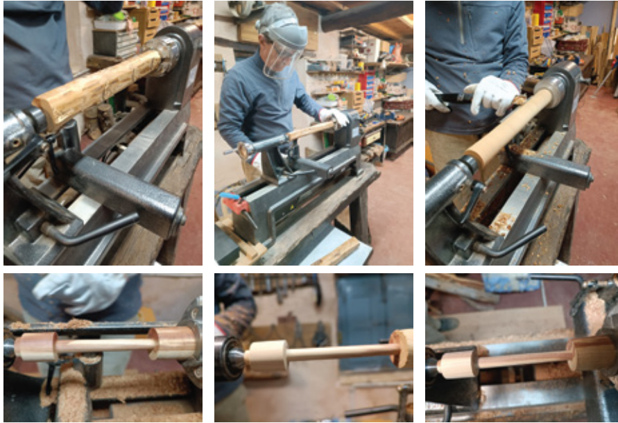
Figura 206. Torneado del molinillo
