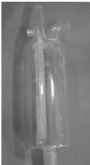
Figura 3.5 Dispositivo empleado para la toma de muestras de cristales
