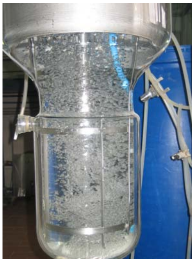
Figura 4.14 Fotografía del reactor lleno de agua y con el sistema de aireación conectado
