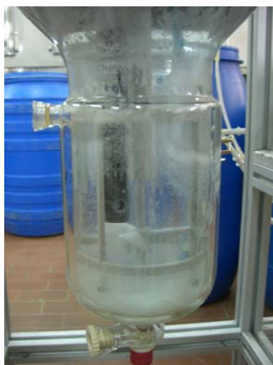
Figura 3.27 Aspecto del reactor después de realizar el ensayo E18 y una vez vaciado
