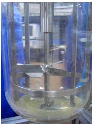
Figura 4.2 Fotografía del anillo de aireación colocado por debajo del agitador
