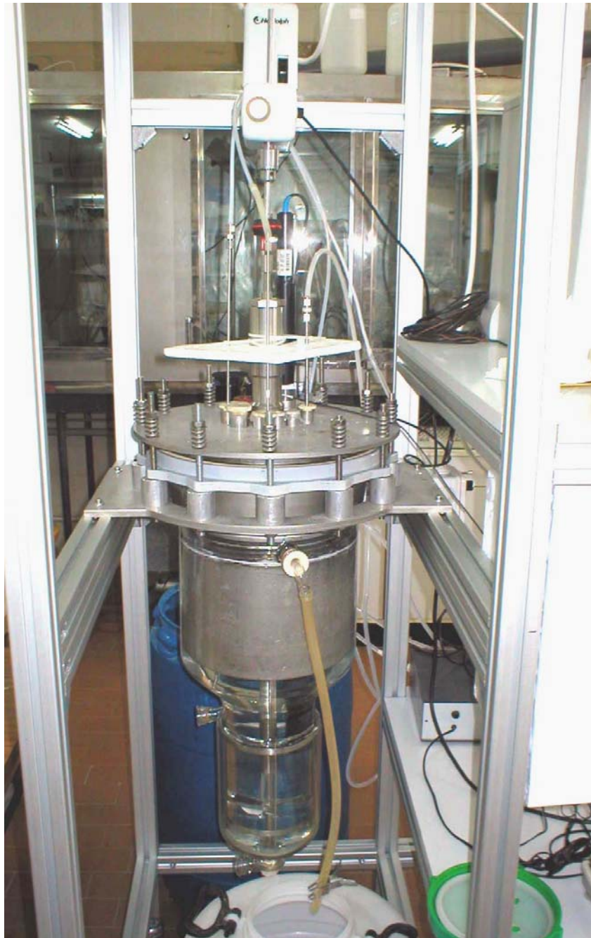
Figura 7.2 Vista frontal del reactor de cristalización
