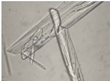
Figura 3.52 Fotografía de cristales de estruvita formados en vaso de precipitados, 40x
