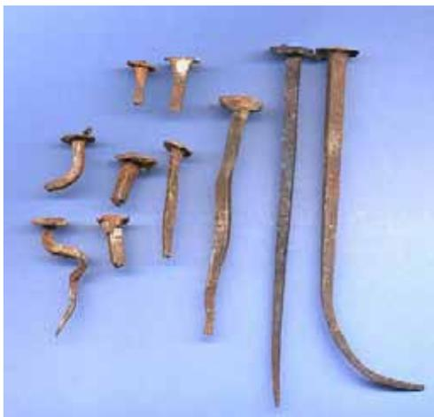
281.- Clavos de forja del siglo xv. Ejemplo de como pueden ser los clavos que sujetan las planchas policromadas a las vigas portantes.
