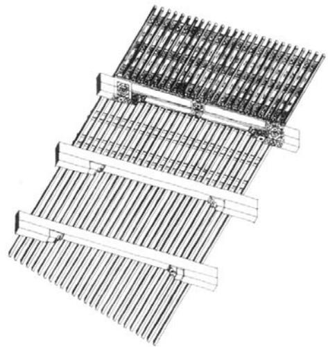
84.- Dibujo de la estructura de un alfarje común.
