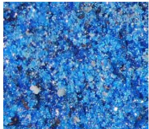
267.- Imagen de microscopio electrónico del azul original, donde se pueden apreciar los cristales propios que componen la azurita o azul de alemania.
