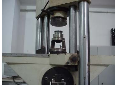
b) Equipo rotura compresión de morteros
