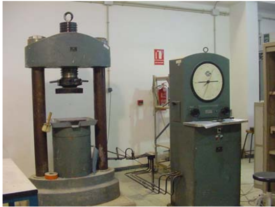
c) Equipo rotura compresión de hormigón.
