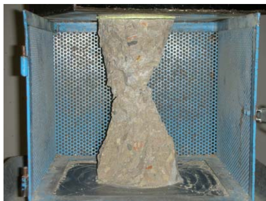
Figura L5. Fotografía de la probeta del hormigón FCC42,5 tras ser sometida a rotura a compresión.
