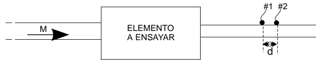
Figura 3.3: Geometría del sistema de medida con la técnica de los dos micrófonos.
