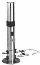
Figura C.7: Dispositivo para la calibración de la amplitud de presión
