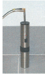
Figura C.6: Calibración del micrófono de medida de presión en cánula
