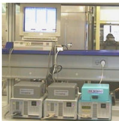
**Figura 4.3.4.** Equipos de medida de  $a_w$  conectados a un ordenador.
