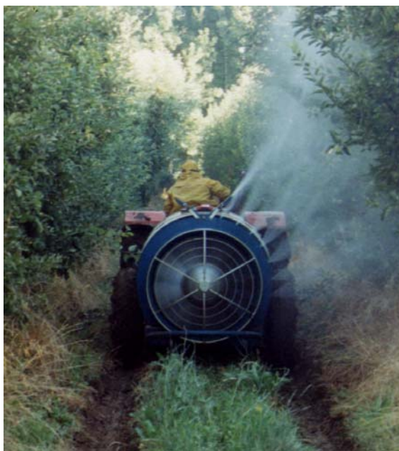
Figura 4: Pulverizador hidroneumático tradicional con ventilador axial
