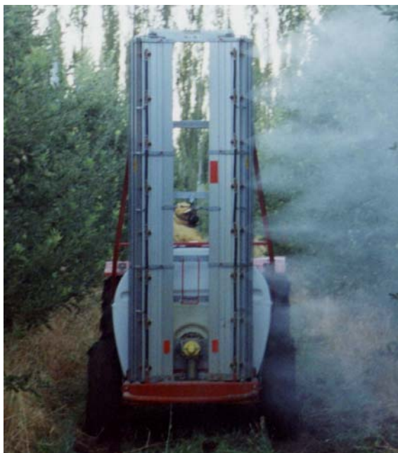
Figura 5: Pulverizador de flujo transversal con ventiladores tangenciales
