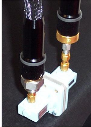
**Figura 4.29:** Montaje para realizar la calibración del analizador de redes HP8510B
