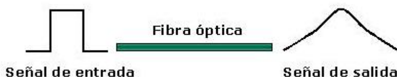
Fig. 1. Ensanchamiento y distorsión de un pulso de luz tras su propagación en una fibra óptica dispersiva
