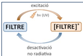
Figura 1. Esquema del funcionament d'un filtre solar.
