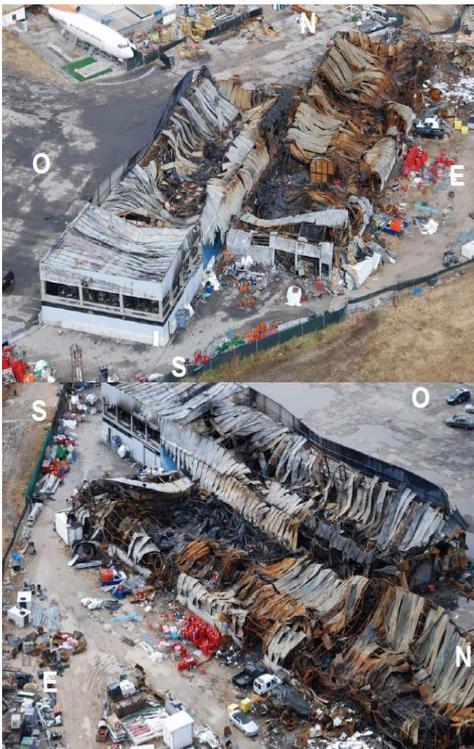
Ilustración 31. Huella de calor en vista aérea
