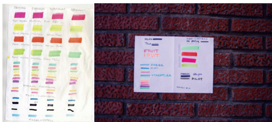
Fig. 70. Prueba de resistencia realizado durante 4 semanas en el exterior. (y detalle)
