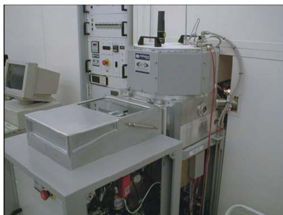
Fig. 29: Detalle del dispositivo encargado del ataque inductivo de plasma ICP.
